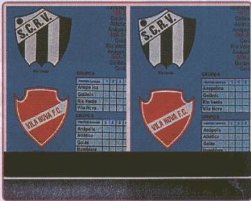
Arrancamento a úmido da camada do papel
