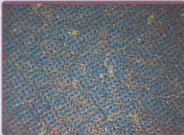
Arrancamento de segmentos de vasos em papel não-revestido
