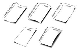
Problema 17 Bordas das folhas onduladas, no sentido das fibras e/ou perpendicular às fibras, causado por absorção de umidade do ar ambiente, provocando problemas na alimentação da impressora, fora-de-registro e rugas.
